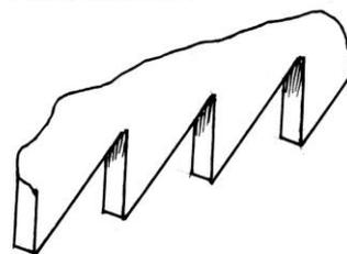
**Задание №19.** Коробки для перевозки бытовой техники делают из многослойного картона. Между плоскими листами вклеены гофрированные (см. рис.). Зачем такие сложности?
